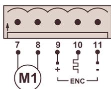
El cuadro puede controlar un motor 24VDC electromecánico con encoder. Los bornes 7, 8 sirven para la conexión del motor.
