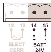
Los bornes 14 y 15 sirven para la conexión de una batería opcional de 24V (o 2 baterías de 12V en serie) para maniobra de emergencia. Esta conexión proporcionará una carga en flotación a la batería de hasta 150mA.
