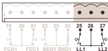
Los bornes 25 y 26 sirven para conectar un pulsador para activar la maniobra completa y los bornes 26 y 27 para la activación de la apertura peatonal o cierre en hombre presente.
