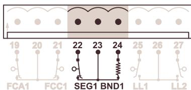
El cuadro distingue dos grupos de seguridades, de banda y fotocélula con una misma conexión común. La banda se puede configurar como resistiva o contacto y la fotocélula siempre es un contacto normalmente cerrado. Ver opciones.
