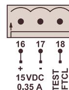
En los bornes 16 y 17, el cuadro cuenta con una salida de tensión para periféricos de 15VDC - 3,5VA protegida mediante fusible rearmable para la alimentación de circuitos externos tales como fotocélulas. Adicionalmente, el borne 18 sirve como negativo específico para realizar test de fotocélula. Según norma.
