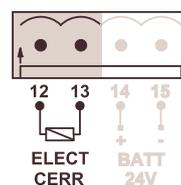
Los bornes 12 y 13 se utilizan para la conexión de una electrocerradura 12/24VDC - 1A. El cuadro debe ser configurado para accionar la electrocerradura y cuenta con opciones como “Golpe de inversión” y “Golpe de ariete”
