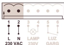
El cuadro recibe alimentación 230VAC 50Hz a través de los bornes 1 y 2. La conexión de tierra se realiza en un conector tipo FAST-ON situado en la parte superior izquierda del cuadro, marcado como EARTH.
