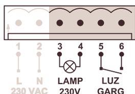
Si se desea, conectar lámpara de 230VAC - 40W en los bornes 3-4 para la señalización de la maniobra mediante destellos. También es posible actuar sobre el pulsador de luz de garaje, o encender una lámpara con temporización mediante las bornas 5-6.
